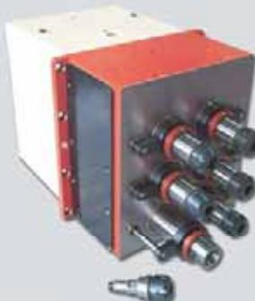
Konzept mit höchster Präzision und hohen Drehzahlen bis 12'000min-1, 2-3-4-6-8 Spindeln, eingebaut in eine 3-Achseneinheit, ermöglicht Werkzeugwechselzeiten von Span zu Span in Nullzeitnähe.
