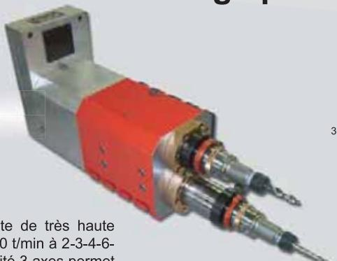
Ce concept de tête de très haute précision et haute vitesse 12000 t/min à 2-3-4-6-8 broches montées sur une unité 3 axes permet d'obtenir des temps de changement d'outils de copeaux à copeaux proche de 0 secondes.
